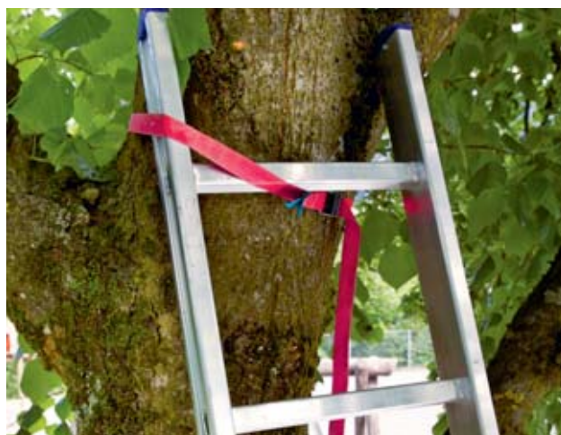
Fig. 28: fissaggio tramite cinghie
