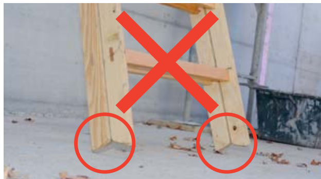
Fig. 39: scala doppia usata in appoggio; il sostegno è solo sul bordo dei piedi.
