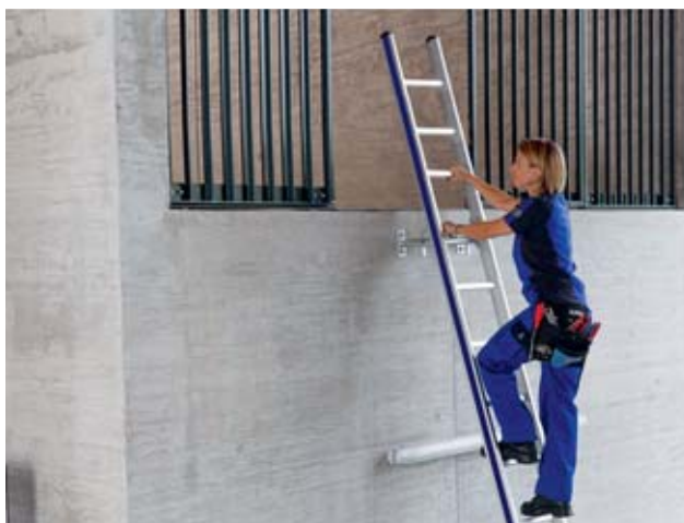
Figg.30 e 31: sguardo e corpo rivolti verso la scala, mani sui pioli e contenitori adeguati (cassetta o tasca portaattrezzi)
