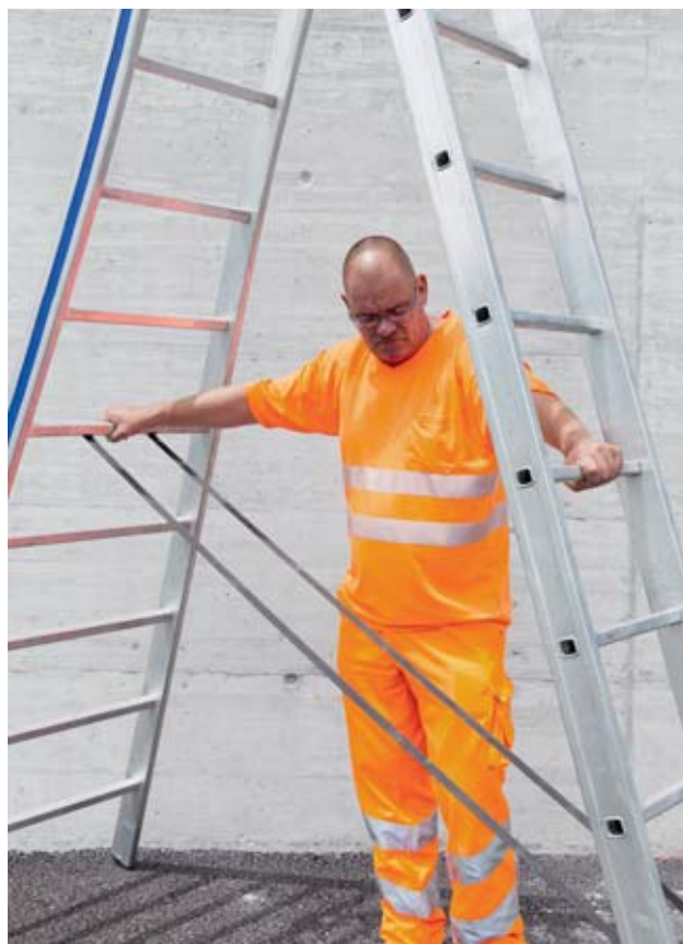
Fig. 40: dispositivo di sicurezza efficace contro l'apertura
