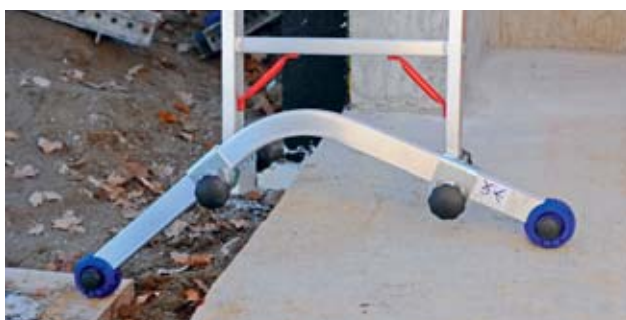
Fig. 34: traversa regolabile in altezza
